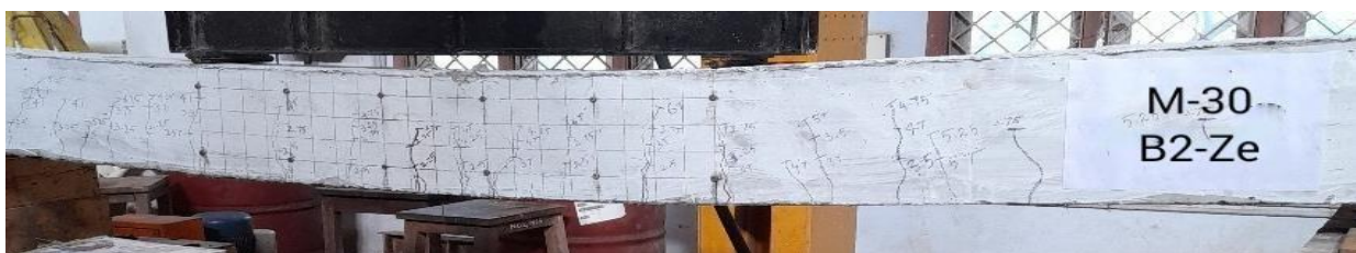
(d) Crack Pattern of B2-Ze Beam
